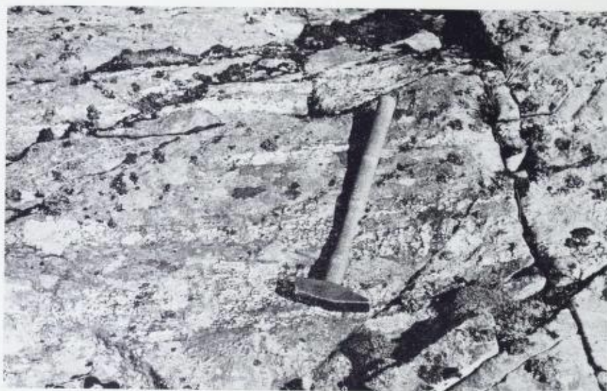
Fig. 6. Vekslende jevnkornet og plagioklas-porfyrisk dioritt. Andalsfeltet. Alternating even-grained and plagioclase-porphyritic diorite. Andal area.
